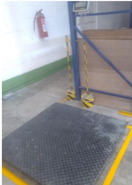
*Ilustración 4.34 Báscula Rhino con capacidad de 2 toneladas. Fuente: Inyectech mexicana.*
